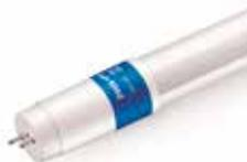
Reemplazo para tubos fluorescentes T8 de 36W. La serie SENSOR LEDtube incorpora un sensor de microondas que provee un 80% de ahorro adicional frente a los tubos LED convencionales cuando no se detecta presencia, es ideal para almacenes y parqueaderos donde es necesario contar con iluminación 24/7
